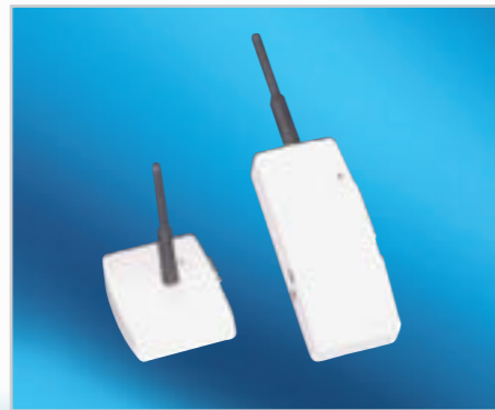
Datenübertragungsgeräte für Flex-Sohlen, Druckmessplatte und andere Messsensoren
