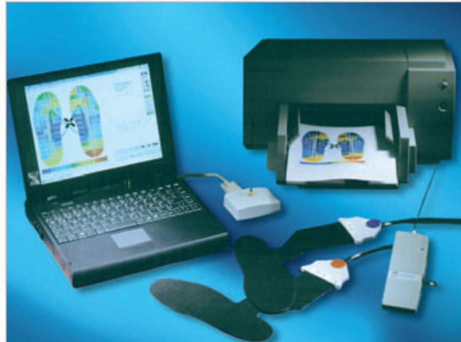
Die System-Komponenten im Überblick: Mess-Sohlen, Sende- und Empfängereinheit, Software, Farbdrucker*, Laptop mit LCD-Monitor*. (* gehören nicht zum Lieferumfang)
