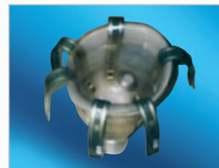
Flexible Messstreifen zur Druckmessung im Prothesenschaft
